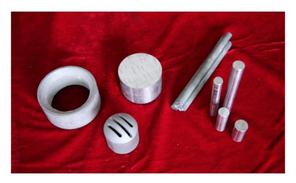
司太立[StelliteF]]合金专门用于气门排气门的硬质表面涂层,以增强气门的抗气蚀性和耐腐蚀性[Stellite4]12合金的硬度均高于Stellite6[]HRC为43~48,具有较高的耐磨性,但抗机械冲击能力较差。司太立4是一种铸造合金,可进行机械加工,具有出色的高温强度。用于铜基合金和铝合金的热压和热挤压模具。司太立12是一种可机加工的硬面合金。可喷涂于地毯、塑料、造纸、化工等行业使用的长刀刀片表面。司太立[Stellite]1[]3[]20三种合金含碳高达2.5%,组织中碳化物含量超过30%。因此,该合金具有很强的耐磨性和耐腐蚀性。
